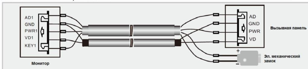
**Внимание:** При подключении панелей серии Stuart или использовании дополнительного реле TS-NC05 для управления воротами, необходимо предусмотреть один дополнительный провод для подключения к шине DATA (смотрите инструкцию на соответствующее устройство).
